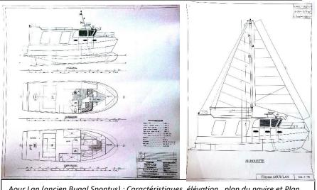
Aour Lan (ancien Bugal Spontus) : Caractéristiques, élévation , plan du navire et Plan de voilure : projet d'installation d'un gréement auxiliaire automatisé (mât bipode)
